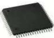
Наличие и тип ЦАП/АЦП: A/D 16x12b; D/A 2x12b
