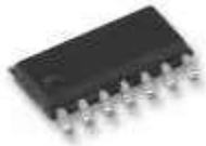
Микроконтроллер AVR 2К-Флэш-память/128-ОЗУ/128-ЭППЗУ/8 и16-бит таймеры/счетчики с ШИМ, 10-бит АЦП, USI, датчик температуры электропитание 1.8...5.5 В
