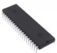
Программируемая логическая интегральная схема 24 макроячейки 20нс 40DIP
